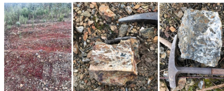
Figuras 7, 8 e 9. Pormenor das escombrelas onde consegue crescer apenas uma espécie de planta ( Rumex bucephalophorus ) tolerante à alta concentração de metais (primeira imagem). Pormenores do minério: veios de quartzo em enxame (segunda imagem) e como cimento de brecha de falha (terceira imagem).
