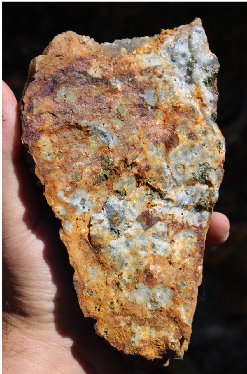
**Figura 7.** Ribeiro de S. Pedro. Brecha cataclástica fortemente silicificada, com sulfuretos primários e hidróxidos de ferro secundários.
