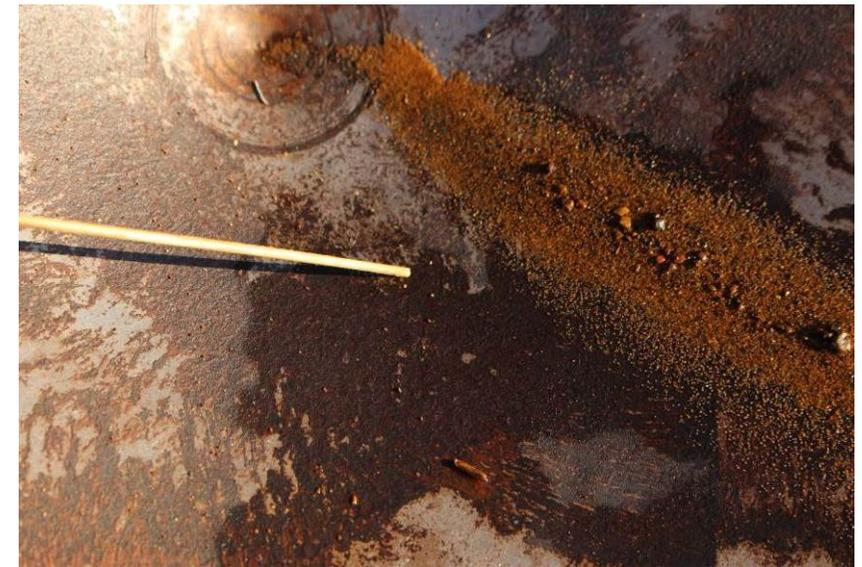
**Figura. 25.** Resultado positivo do ensaio à bateia do depósito aurífero efectuado a partir de duas amostras de sedimento recolhidas nos trabalhos mineiros.
