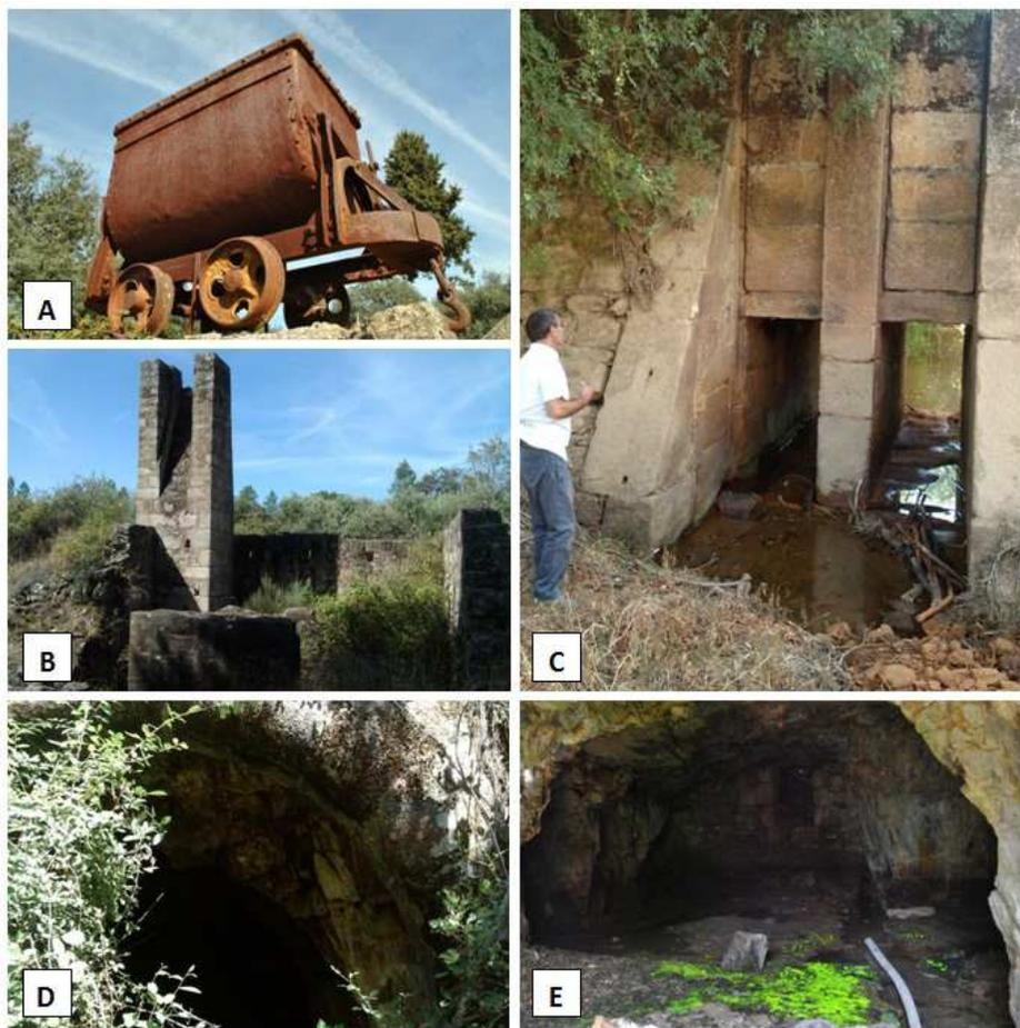
**Figura 20.** Minas da Mata da Rainha: **A**, vagoneta, ferramenta de transporte para movimentação de minério e materiais no processo de mineração; **B**, antigas instalações das lavarias; **C**, antigas comportas do açude, para retenção da água; **D**, **E**, entradas para as galerias mineiras.
